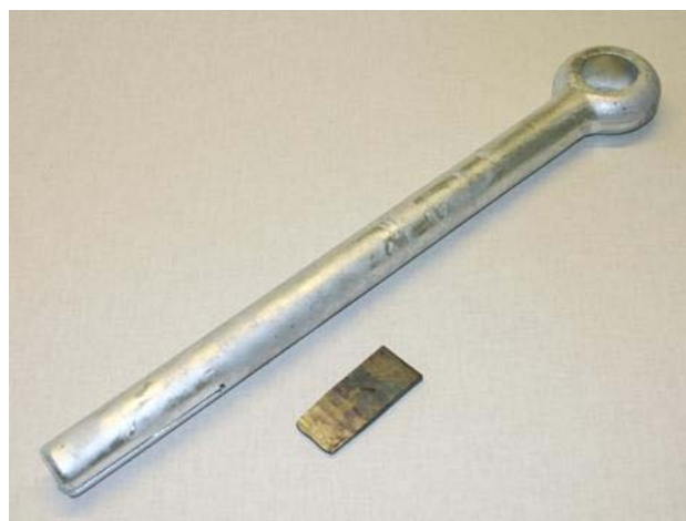
Figur 3 ANJA fortøyningsbolt med kile, smidd legert stål, seigherdet og varmforankret. Foto: Erling Haug AS
